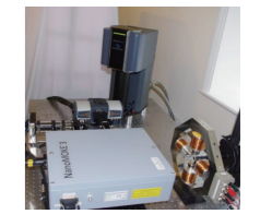
图 2: DMO 和 Montana 公司联合研发的 CryoMOKE
