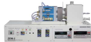
图 5: 塞贝克系数 / 电阻测量系统 ZEM-3
