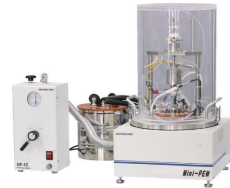
图 1: 小型热电转换效率测量系统 Mini-PEM
