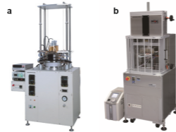
图 4: 左图为热电转换效率测量系统 PEM-2,右图为大气环境下热电材料性能评估系统 F-PEM
