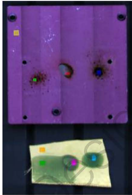
图 10. Specim FX50 相机采集的伪彩色图像
